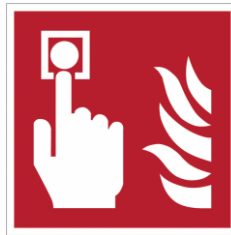
Pulsante di allarme antincendio
