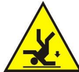
Segnaletica di pericolo: caduta dall'alto
