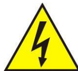
Segnaletica di pericolo: folgorazione
